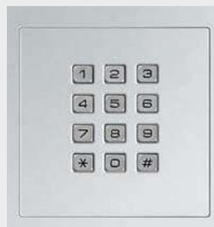
Durch die Integration des Codeschlusses können Sie Türen und Eingänge einfach mittels Codeeingabe öffnen. Bei Eingabe einer 1- bis 4-stelligen Codenummer wird über den Steuerkontakt der Serie 5 z. B. ein angeschlossener Türöffner aktiviert. Pro Steuerkontakt sind zwei verschiedene Codenummern möglich. Die Tasten des Codeschlusses sind blau hinterleuchtet
